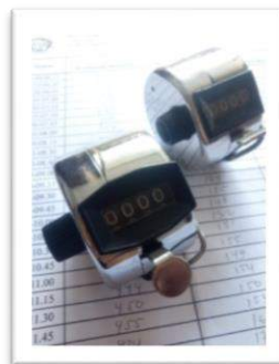
Gambar 6 Alat TallyCounter untuk Menghitung Jumlah Kendaraan
